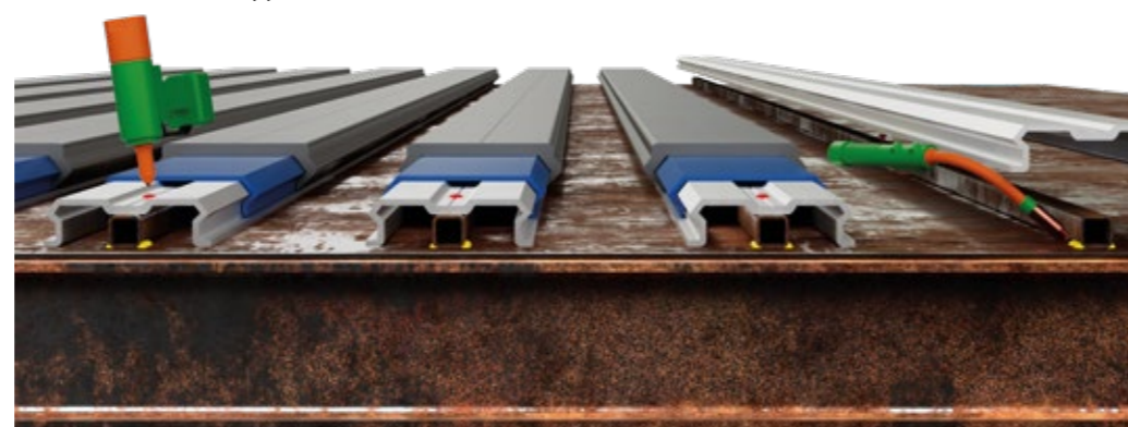
Свободные алюминиевые подпалубные профили, заклепанные на стальном коробчатом профиле, приваренном к стальной пластине.
