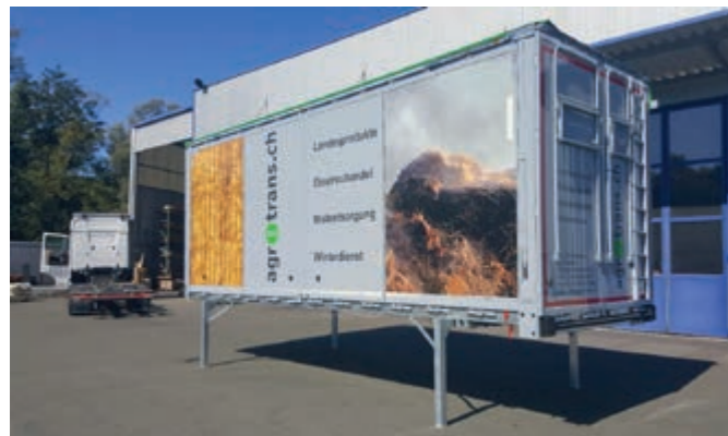
Feuerverzinkter Rahmen (Option) KTL ist Standard
