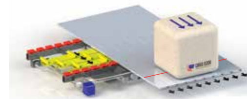
La fase 1 viene ripetuta nuovamente. La velocità di ripetizione di queste fasi può essere regolata in modo variabile in base alla portata dell'olio idraulico.
