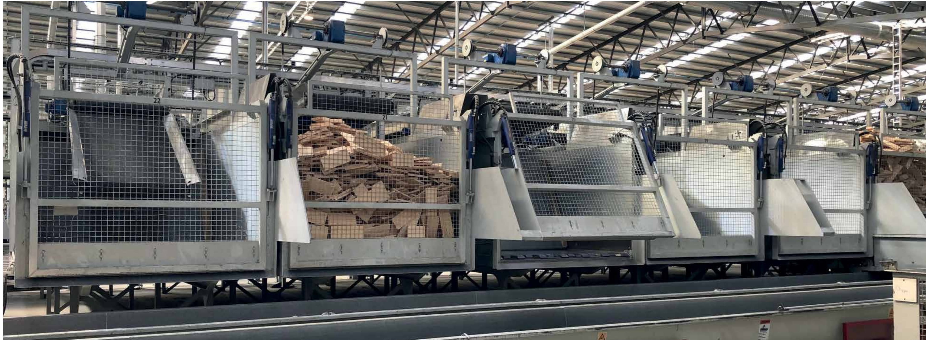
La fase 1 viene ripetuta nuovamente. La velocità di ripetizione di queste fasi può essere regolata in modo variabile in base alla portata dell'olio idraulico.
