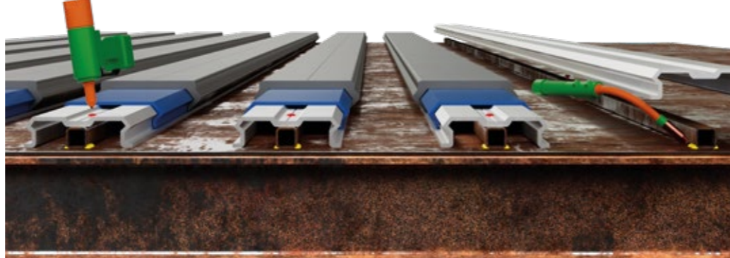
Lose Aluminium-Unterdeckprofile, die auf ein mit einer Stahlplatte verschweißtes Kastenprofil genietet sind.
