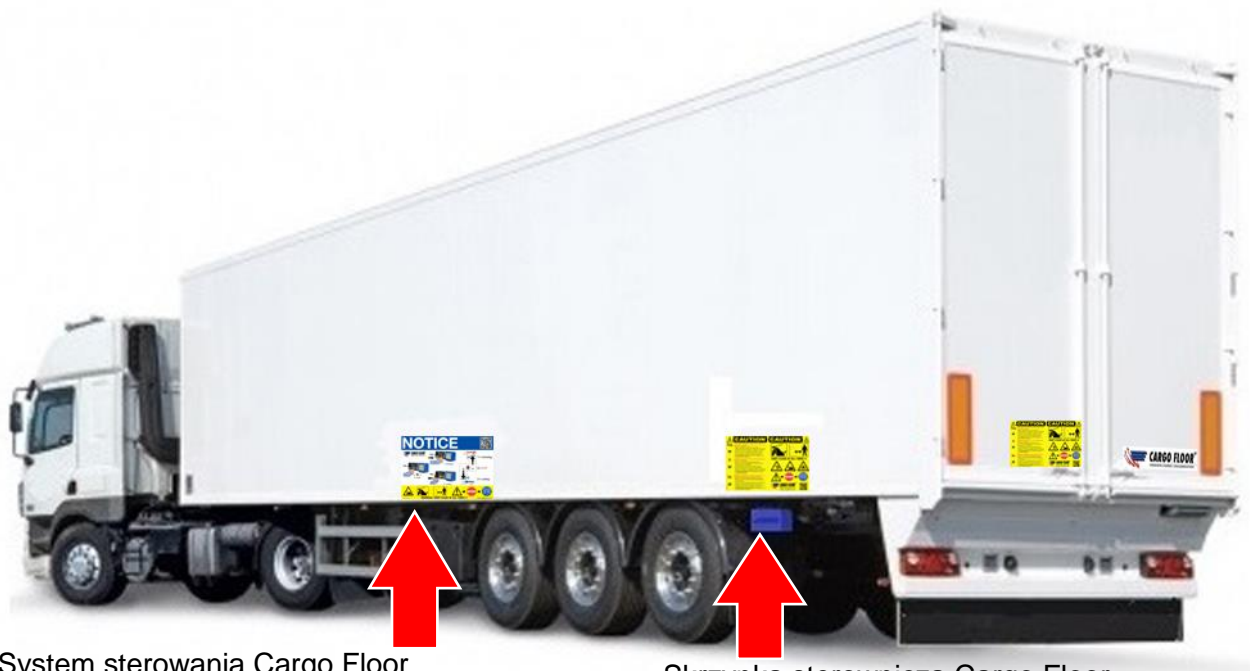
Skrzynka sterownicza Cargo Floor (może znajdować się w innym miejscu) System typu B lub E (przełączniki)
