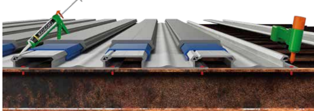
Perfiles deslizantes de aluminio remachados sobre travesaños de acero y sellados con sellador.
