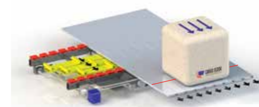
Stap 1 wordt opnieuw herhaald. De snelheid waarmee deze stappen worden herhaald, kan variabel worden ingesteld afhankelijk van de hydraulische oliestroom.
