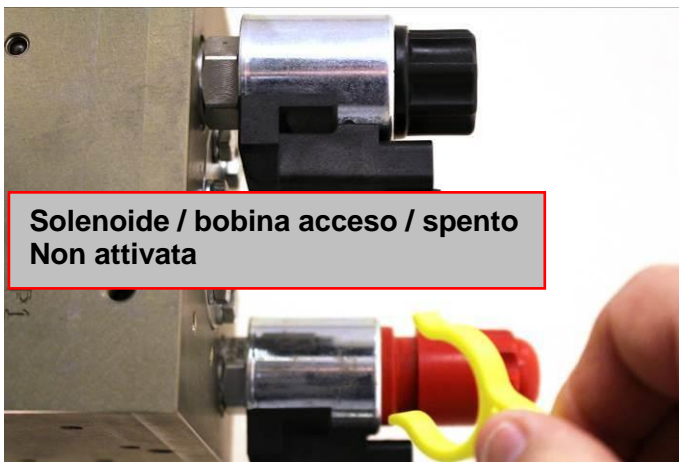
Solenoido / bobina acceso / spento Attivata manualmente
