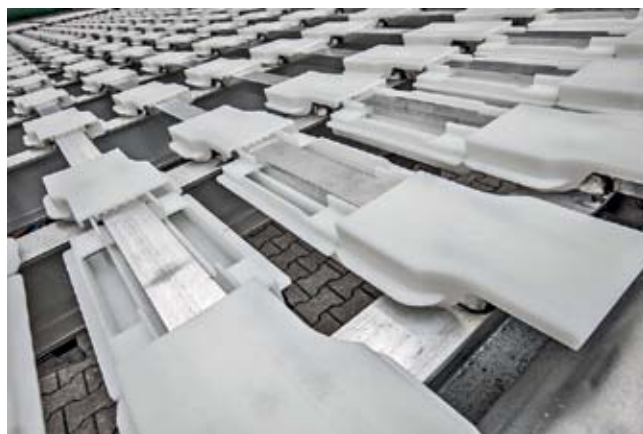
"Twister Largo" & "Blocchetto di Supporto Speciale Largo" (anti sollevamento)
