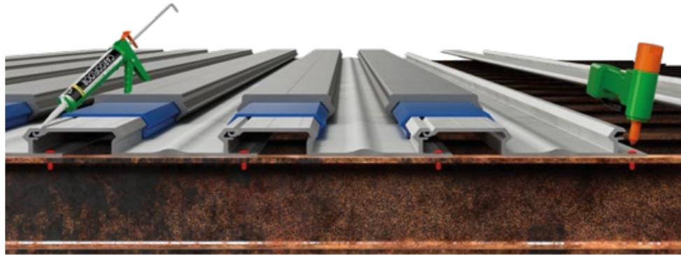
"滑入式"铝制底甲板型材与钢制横梁铆接,并用密封胶密封。
