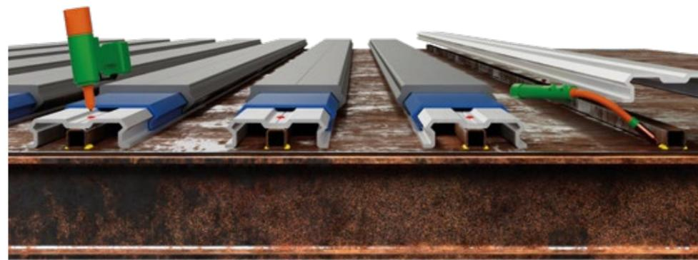
松散的铝制底层型材铆接在焊接在钢板上的钢箱型材上。
