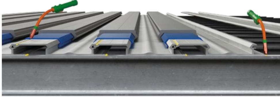
"滑入式"副甲板型材焊接在铝横梁上(也可铆接),通过全长焊接密封。
