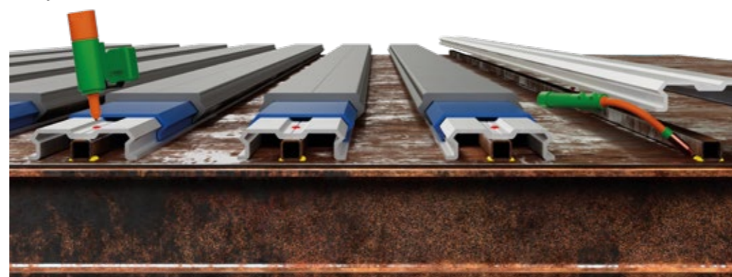
鋼板に溶接された鋼製ボックスセクションに、ルーズなアルミ製サブデッキ・プロファイルがリベット留めされている。
