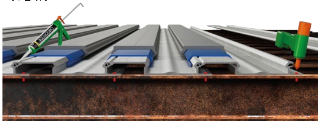
「スライド・イン」アルミ製サブデッキ・プロファイルは、スチール製クロスメンバーにリベットで固定され、シーリング材で密閉されている。
