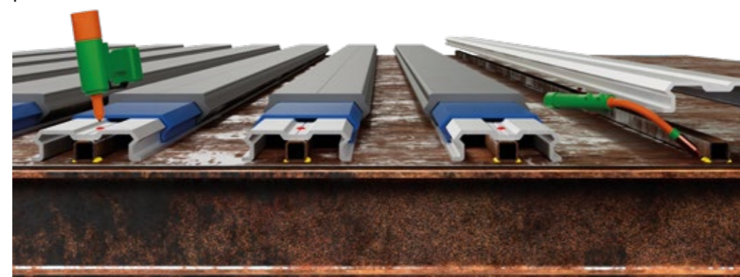
Atslābināti alumīnija apakšklāja profili, kas savienoti ar tērauda kārbas profilu, kas piemetināts pie tērauda plāksnes.
