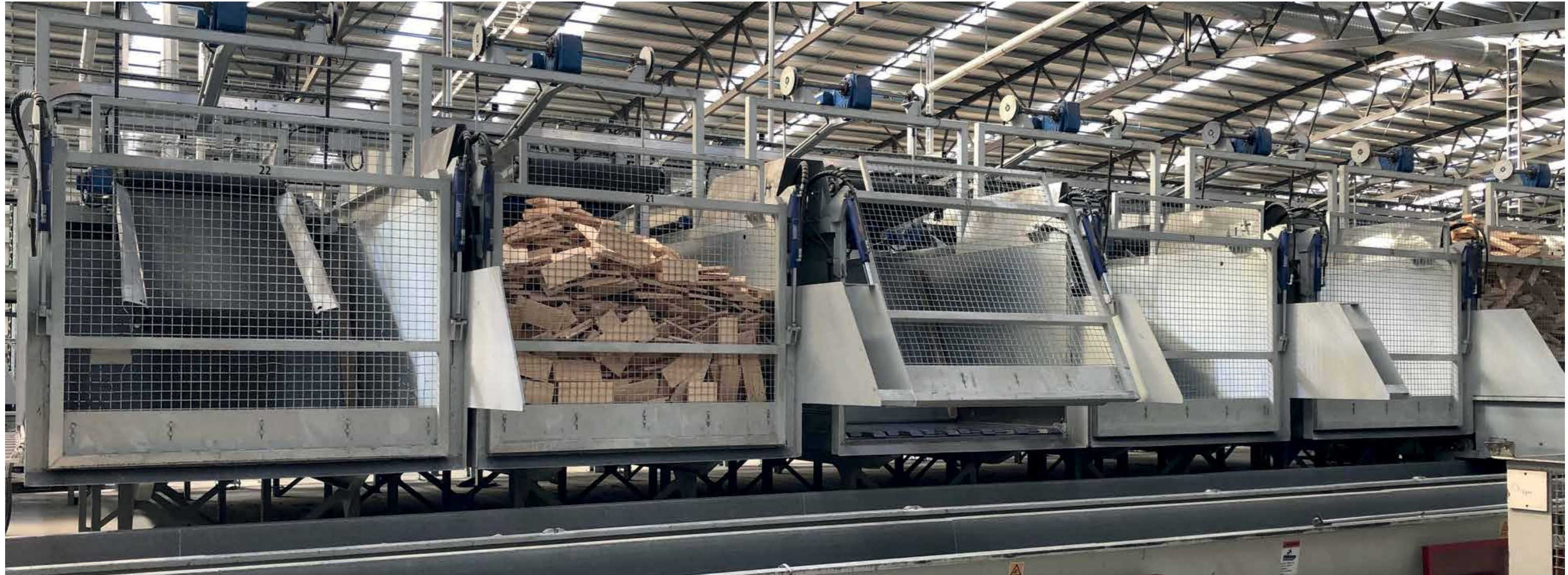
第1步:三个液压缸均可移动 在选定的方向上移动整个地板,从而 移动产品。
