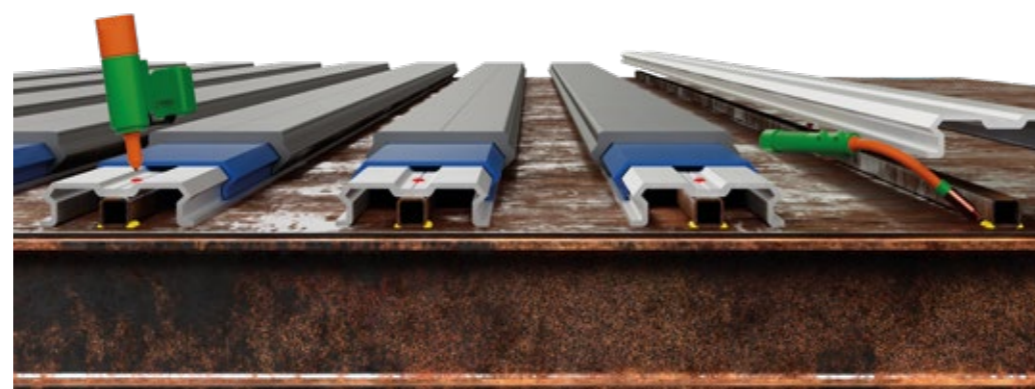
Losse aluminium onderdekprofielen geklonken op een stalen kokerprofiel gelast op een stalen plaat.
